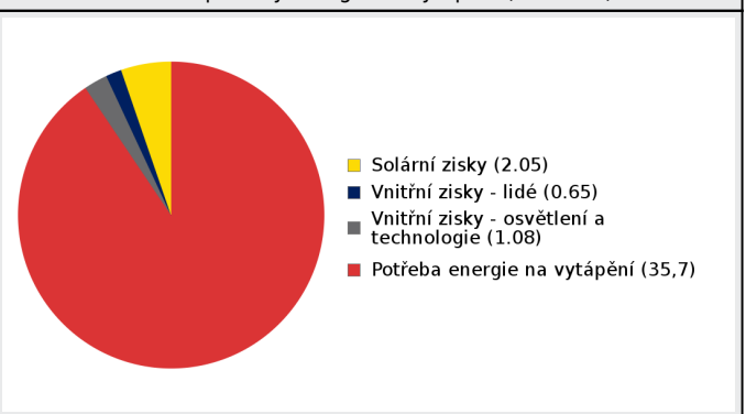
Bilance potřeby energie na vytápění (MWh/rok)
